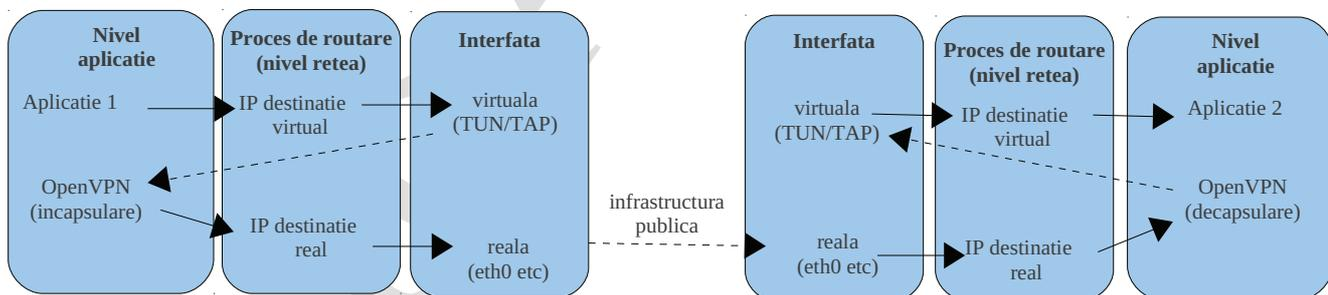
Interfetele de tip TUN sunt interfete care lucreaza in mod point-to-point si care opereaza la nivel retea (aplicatia pereche trebuie sa genereze – si va primi inapoi – pachete IP). Interfetele TAP sunt interfete ethernet, iar aplicatia care le utilizeaza trebuie sa genereze/prelucreze frame-uri.
